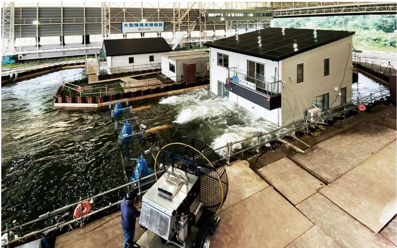
一条工務店は防災科学技術研究所と「耐水害住宅」の性能実験をした=同社提供
